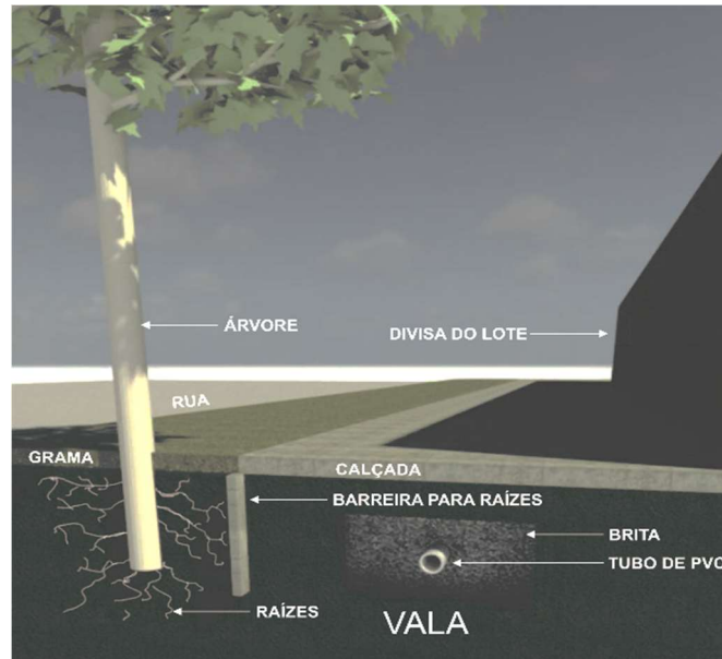
Figura 3 – Esquema da proposta para vala de infiltração.
